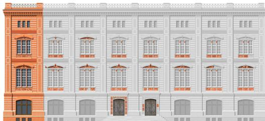
F5: Nordfassade: Achse 1 = Musterfassade und Achsen 2 – 8 (grau) mit Einfügungen vorhandener Reliefplatten und Terrakotten
